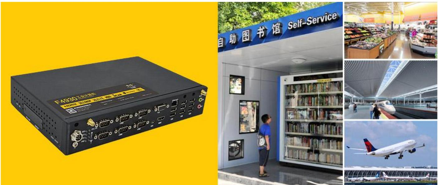
**F4930** 是四信公司自主研发的一款低功耗工业计算机，融合了无线蜂窝网络和路由技术与工业计算机技术，系统采用 Freescale Cortex™-A9 i.MX 6 Quad 处理器，主频为 1GHz，为客户任务程序提供高速运算支持。支持 OpenGL ES2.0 和 OpenVG™1.1 硬件加速器，全高清 1080P 视频编解码引擎，为多媒体播放提供流畅强劲的视频体验。F4930 包含 8 个 USB、6 个 RS232、HDMI、VGA、音频、GPIO 等接口，可外接扫码枪、打印机、摄像头、键盘、鼠标、红外屏、液晶屏等设备，不再为接口少而困扰。内置 Android 操作系统并提供相关 API 及开发文档，让客户使用与开发应用更为简单方便。
