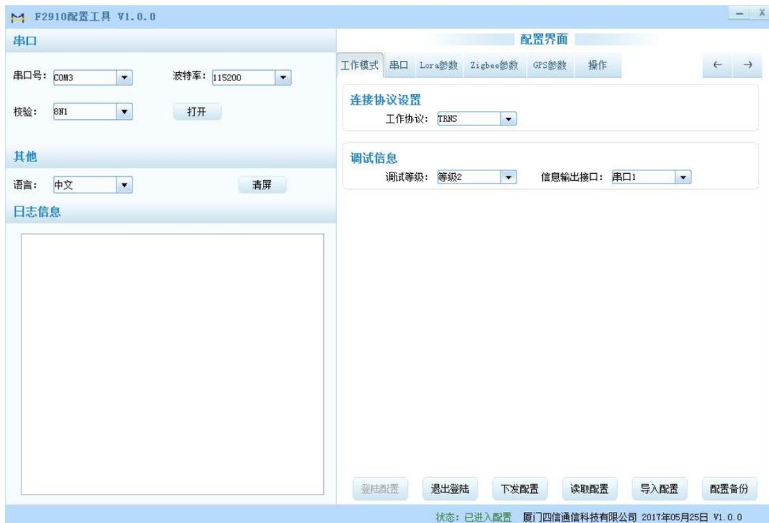
在串口参数设置栏内显示当前打开串口的串口参数，默认情况下是 COM1，115200，并且串口已经打开，如果您连接 NB-IoT 终端的实际串口参数不相符，请在此项配置中选择正确的值，同时打开串口。串口参数设置栏内的右边按钮若显示为“关闭串口”，表明串口已经打开，否则请打开串口。串口打开时，在输出信息栏内会给出提示信息：串口 (COM) 已打开，请重新上电设备，正在等待设备上电后进入配置状态...
