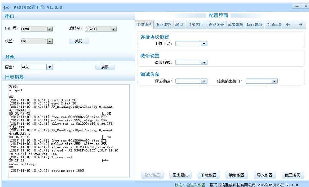
重新上电后配置工具会使 NB-IoT 终端进入登入配置状态，点击“读取配置”载入设备中的当前配置参数，并显示在右边的“配置界面”中，至此可以开始配置 NB-IoT 终端中所有配置参数。
