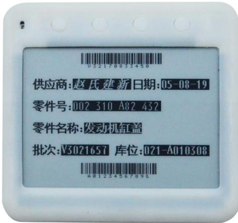
F8L10E-A 电子标签采用先进的电子墨水屏以及超低功耗 LoRa 组网技术, 替代传统纸质标签, 摆脱手动更换标签存在的各种问题, 提供更加智能、高效的管理模式。
