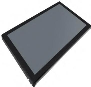
F4934 系列中 21.5 寸一体屏是四信公司自主研发的一款低功耗工业计算机，融合了无线蜂窝网络、路由技术与工业计算机技术、液晶显示为一体的工业计算机。系统采用 Quad-core ARM Cortex-A17 RK3288 处理器，主频为 1.8GHz，为客户任务程序提供高速运算支持，可提供流畅强劲的视频体验。包含 4 个 USB、3 个 RS232、1 个 RS232/RS485、网络、音频等多种形态接口，可外接扫码枪、打印机、摄像头、键盘、鼠标等设备，不再为接口少而困扰。内置 Android 操作系统并提供相关 API 及开发文档，让客户使用与开发应用更为简单方便。
