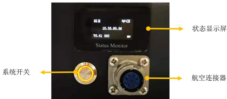
步骤一：按下“系统开关”，设备即可自检启动，开关自带 LED 状态灯指示。
