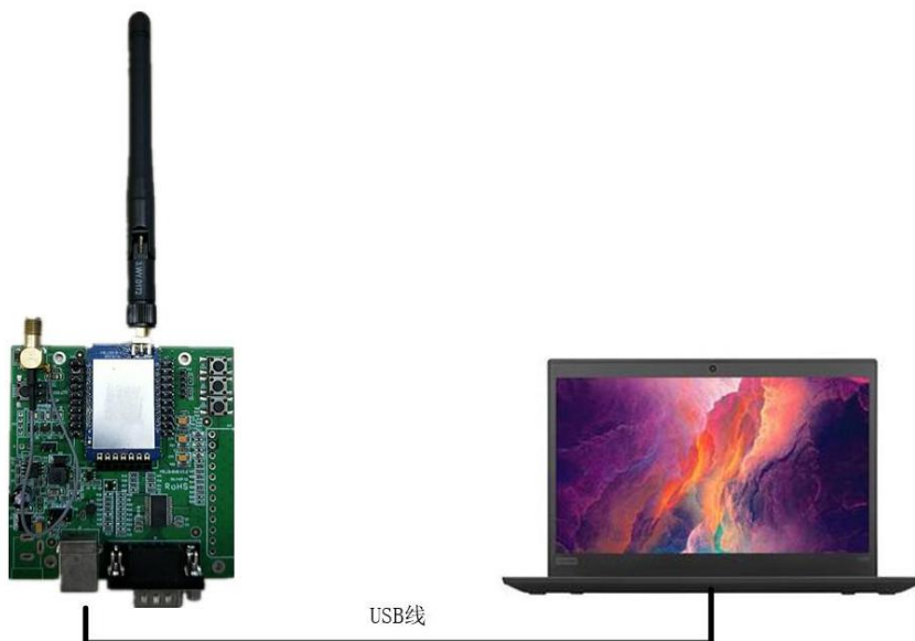
图 4-1 F8L10A 系列与 PC 的配置连接
